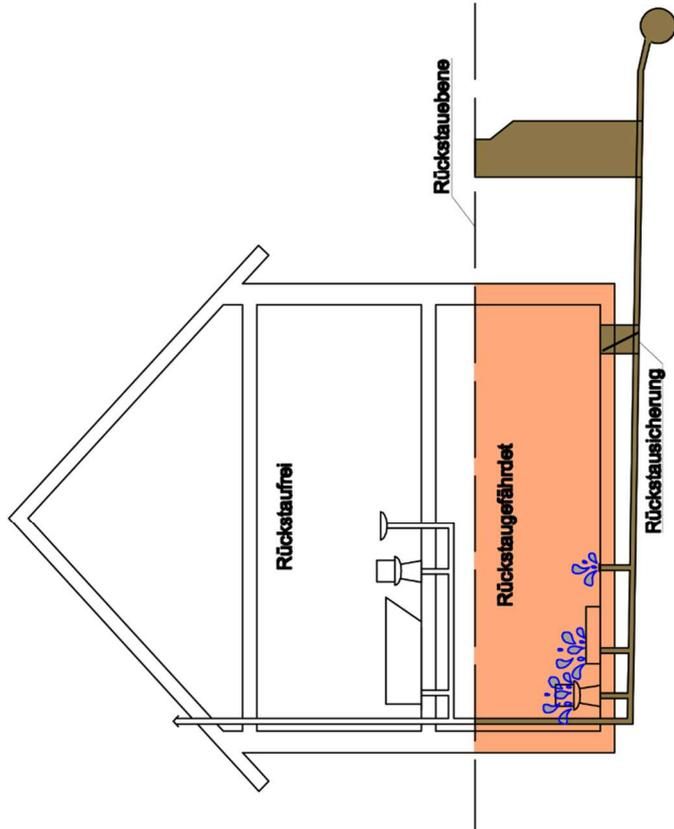
Sämtliche Entwässerungsgegenstände des Gebäudes sind gegen Rückstau aus dem Kanal gesichert, auch diejenigen, die oberhalb der Rückstauabene liegen. Bei geschlossener Rückstausicherung kann zwar kein Abwasser aus der Kanalisation austreten, aber durch das anfallende Abwasser der oberhalb der Rückstauabene gelegenen Entwässerungsgegenstände im Haus kann es zu Überflutungen der tieferliegenden Räume kommen.
